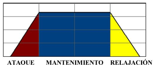
Figura 2.16: Fases de la envolvente genérica de una nota emitida por un instrumento.
