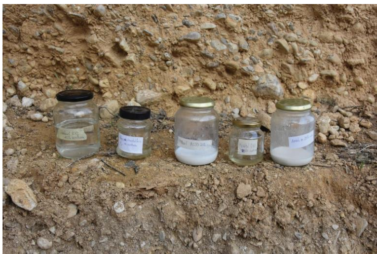
Fig 23. Consolidantes en disolución. De izquierda a derecha: resina acrílica Paraloid B72 en acetona, adhesivo nitrocelulósico en disolución, resina vinílica Acril AC33 en agua, butiral de polivinilo Mowital B60 en acetona y acetato de polivinilo en agua. Imagen: el autor.
