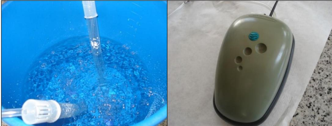
**Figura 63:** Aireación de la muestra y bomba difusora. Pruebas en laboratorio (ETAP Contraparada de Murcia)
