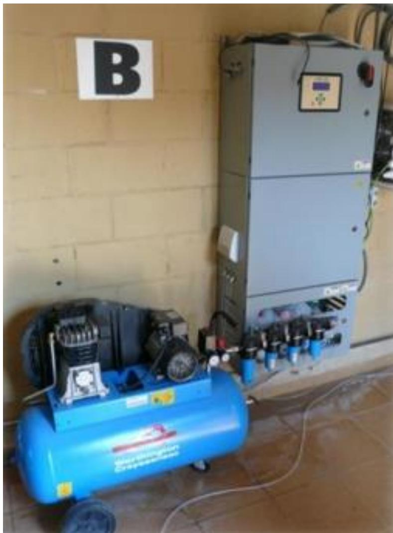
**Figura 23:** Analizador en continuo de THMs
