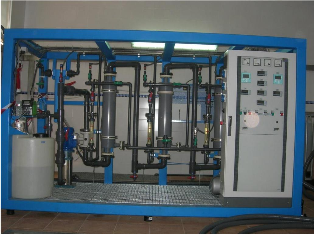
**Figura 62:** Planta piloto de contactores de membrana para la eliminación de THMs instalada en Murcia
