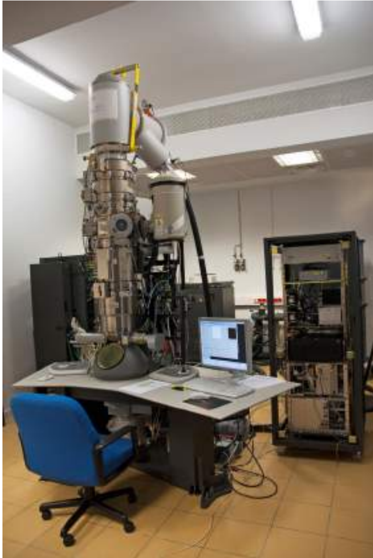
Figure 3.4. High-resolution transmission electron microscope at the Centro de Instrumentación Científica de la Universidad de Granada (Spain).
