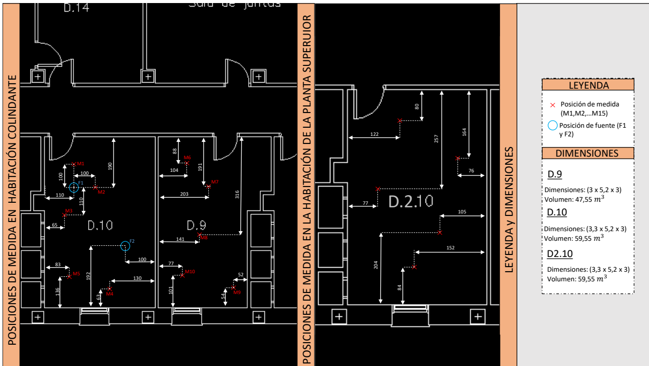
Figura 3.1 – Plano de posiciones de puntos de medida y fuentes
