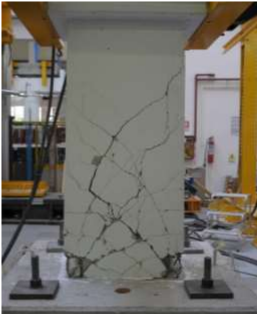
Figura 196: Quadro fessurativo di fine prova per la pila snella P1 (a sinistra) e tozza P3 (a destra)
