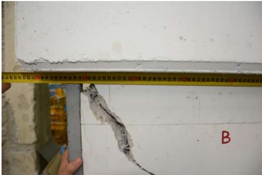
Figura 90: Misura dello scorrimento dei due triangoli
