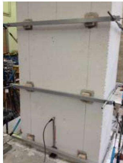
Figura 18: Esempio di Disposizione strumentazione
