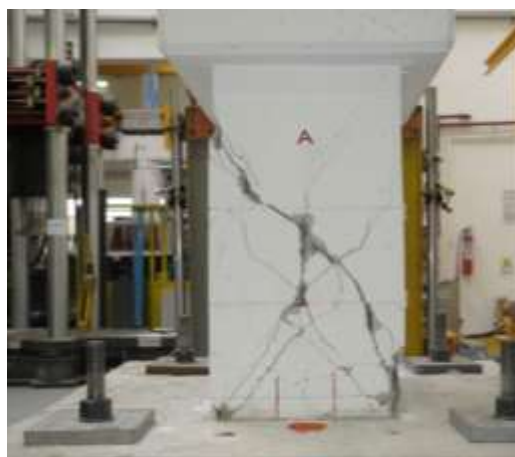
Figura 120: Quadro fessurativo finale Pila P4
