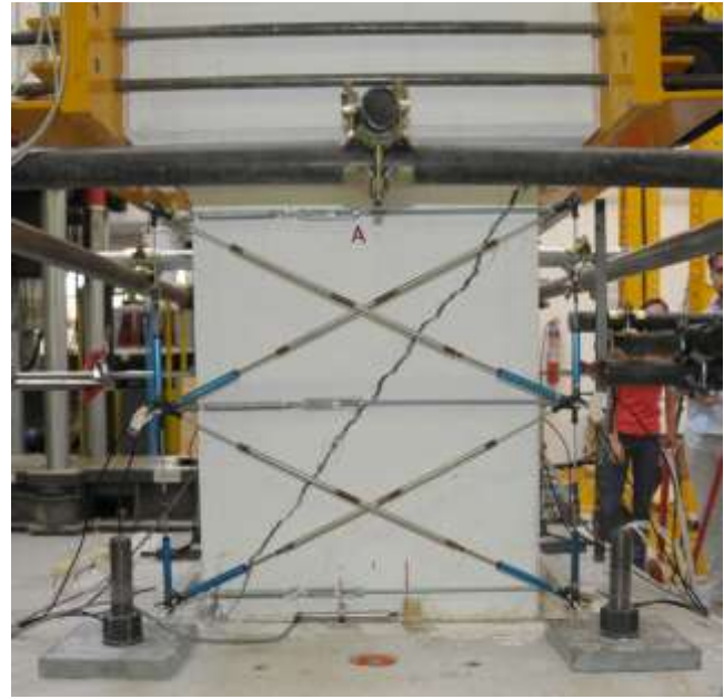
Figura 196: Quadro fessurativo di fine prova per la pila snella P1 (a sinistra) e tozza P3 (a destra)
