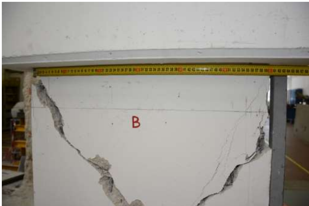
Figura 89: Quadro di danneggiamento finale Lato B –Pila P3
