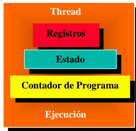
Fig. I.14. Modelo genérico de un Thread
