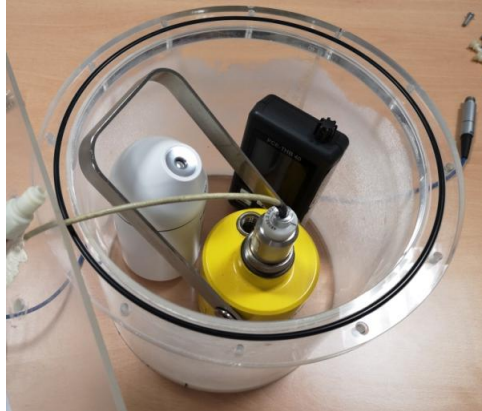
Figura 4: Montaje experimental empleado para cámara PTW Farmer Chamber Type 23333.
