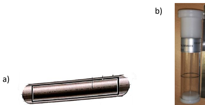
Figura 9: a) Fuente radiactiva IsoSeed ^{125}\text{I} .s17plus [8] y b) alojamiento de PMMA.
