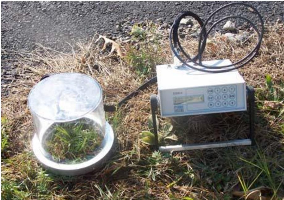
**Figura 2.** Imagen del sistema de medida de intercambios de CO<sub>2</sub> del suelo EGM-4/CPY-4. A la izquierda está la cámara colocada sobre un collar de PVC. Esta cámara es la encargada de captar y transportar el aire hasta la unidad de control (a la derecha). En la unidad de control se analiza el contenido de CO<sub>2</sub> del aire mediante un analizador de gases por infrarrojo.
