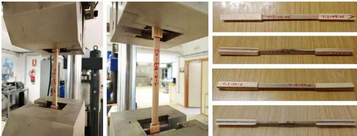
Figura 263. Probetas del ensayo de tracción vertical paralela a las fibras. Izquierda y centro: Probetas sin nudo expuestas al aire libre colocadas en la prensa. Derecha: Probetas con y sin nudo procedentes de la cámara climática listas para ser ensayadas.
