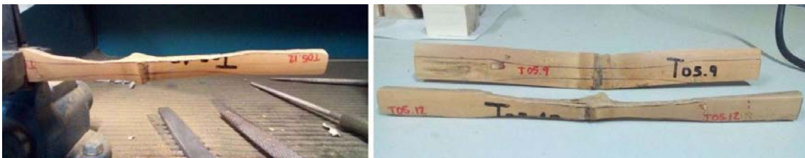
Figura 233. Elaboración de probetas de Bambusa vulgaris Vulgaris . Izquierda: Probeta en proceso de lijado. Derecha: Comparativa entre el estado inicial y final de las probetas.
