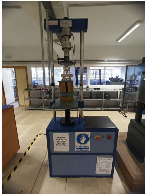
Figura 265. Prensa eléctrica multiensayos modelo S-110 del Grupo EP INGENIERÍA DE INSTRUMENTACIÓN Y CONTROL S.A.
