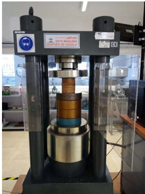
Figura 261. Prensa hidráulica de la marca IIC grupo EP, modelo IC-200-CO con una probeta lista para ser ensayada.
