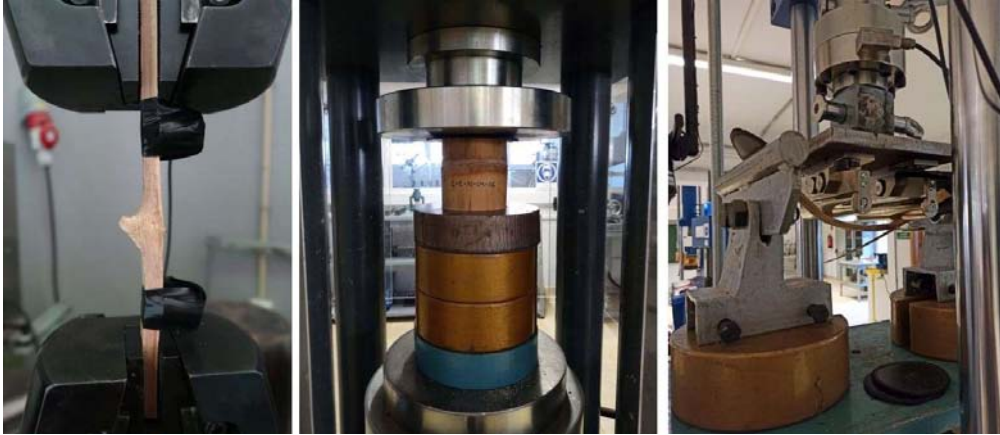
Figura 17. Ensayos de laboratorio realizados en esta Tesis Doctoral. Izquierda: Ensayo de tracción paralela a la fibra de la Bambusa vulgaris Vulgaris . Centro: Ensayo de compresión paralela a la fibra de la Guadua angustifolia Kunth . Derecha: Ensayo de flexión de la Guadua angustifolia Kunth .
