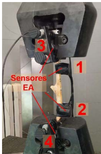
Figura 239. Probeta en la máquina de ensayos con los cuatro sensores VS45-H
