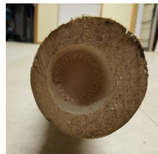
Figura 203. Sección de una caña de Bambusa vulgaris Vulgaris salvaje donde se aprecia el grosor de sus paredes y la excentricidad de su oquedad
