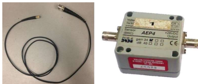
Figura 244. Transmisión de la señal desde el sensor al preamplificador. Izquierda: Cable sensor-preamplificador de 1.20 m de longitud. Derecha: Preamplificador AEP4 de Vallen Systeme. Fuente: Adaptada de Martínez Jiménez (2016).
