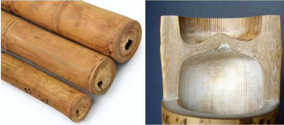
Figura 144. Guadua angustifolia Kunth seca. Izquierda: Culmos cortados y curados. Derecha: Culmo seccionado. Fuente: Bambusa Estudio (Izquierda) / Palakas (Derecha).
