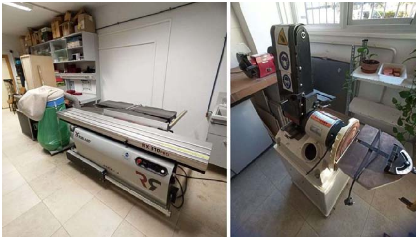
Figura 255. Máquinas empleadas en la elaboración de las probetas de compresión. Izquierda: Combinada multifunción ROBLAND NX 310 Pro. Derecha: Lijadora combinada de banda/disco de la marca JET, modelo JSG-96CS.
