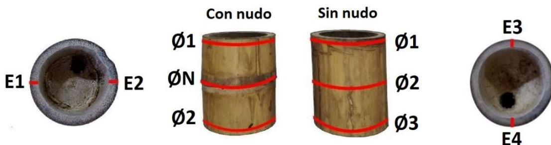
Figura 250. Ubicación de los puntos donde fueron tomadas las medidas en las probetas de Guadua angustifolia Kunth del ensayo de compresión vertical paralela a las fibras.
