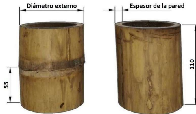
Figura 249. Dimensiones (en mm) de las probetas del ensayo de compresión vertical paralela a las fibras.
