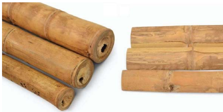
Figura 224. Guadua angustifolia Kunth del ensayo. Izquierda: Cañas. Derecha: Latillas. Fuente: Bambusa Estudio.
