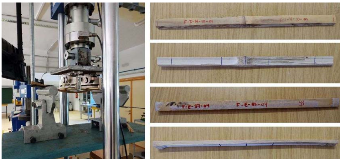
Figura 269. Probetas del ensayo de flexión en 4 puntos. Izquierda: Probeta siendo ensayada. Derecha: Probetas listas para ser ensayadas.
