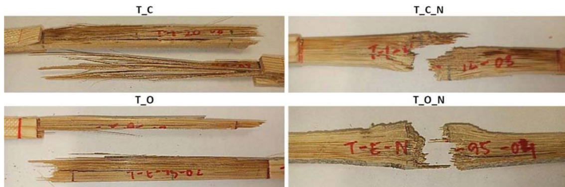
Figura 292. Imágenes de las probetas después del ensayo de tracción vertical paralela a las fibras.
