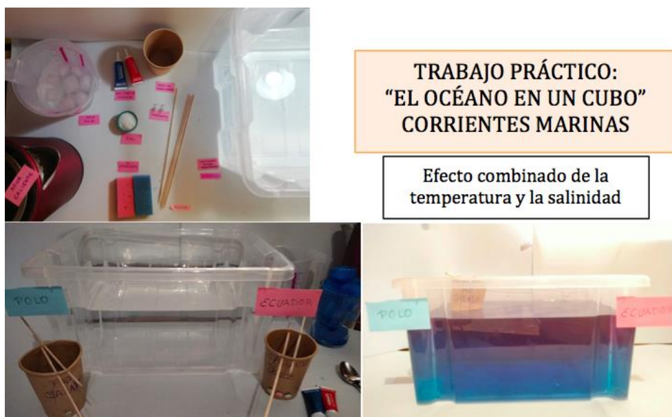
Figura 14. Trabajo práctico “El océano en un cubo”. Efecto combinado de temperatura y salinidad. Se muestra el material, procedimiento y resultados del trabajo práctico “El océano en un cubo”. Corrientes marinas. Las imágenes se muestran a mayor tamaño en el Anexo J.
