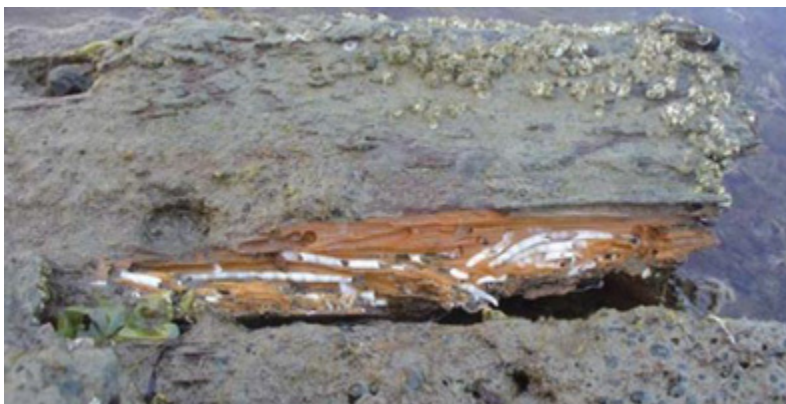
Figura 6: Tubos calcáreos de xilófagos, la presencia de estos invertebrados ha repercuido considerablemente en la resistencia de la madera, lo que se ve reflejado en los resultados de densidad que presentan estas muestras.
