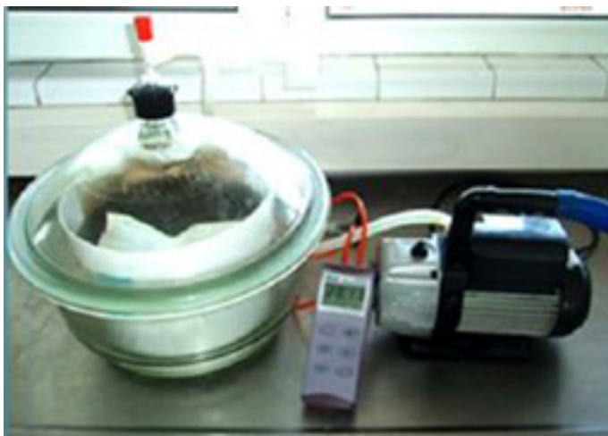
Figura 7: Proceso de plastinación de materiales orgánicos.
