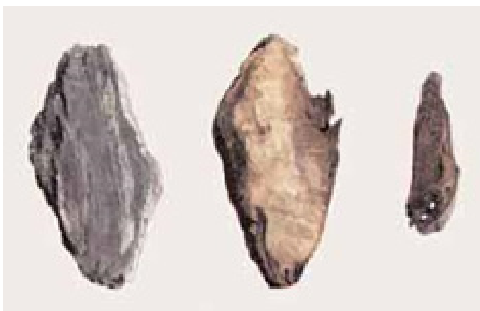
Figura 9: De izquierda a derecha, madera tratada, madera sin tratar-secado controlado, madera sin tratar secado libre.
