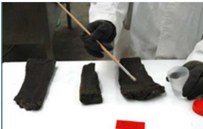
Figura 8: Intervención de madera saturada por humedad, estabilización mediante filtración de la pieza.
