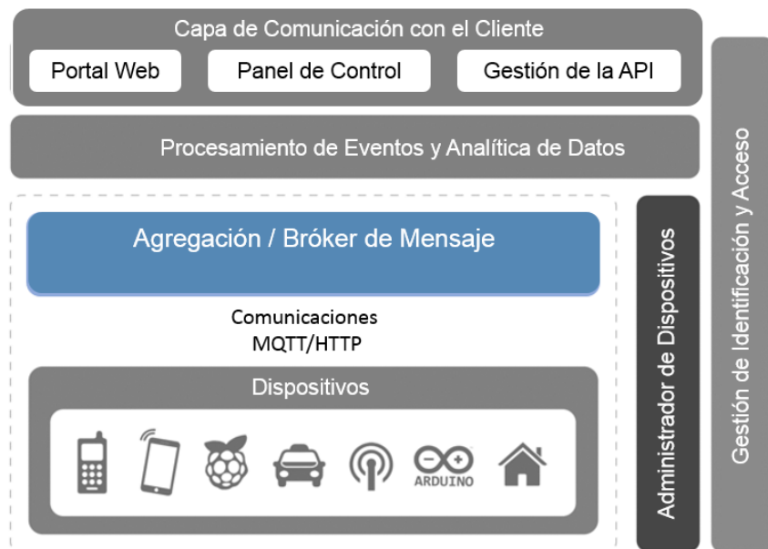
FIGURA 1.7: Arquitectura de referencia de IoT según Fremantle.
