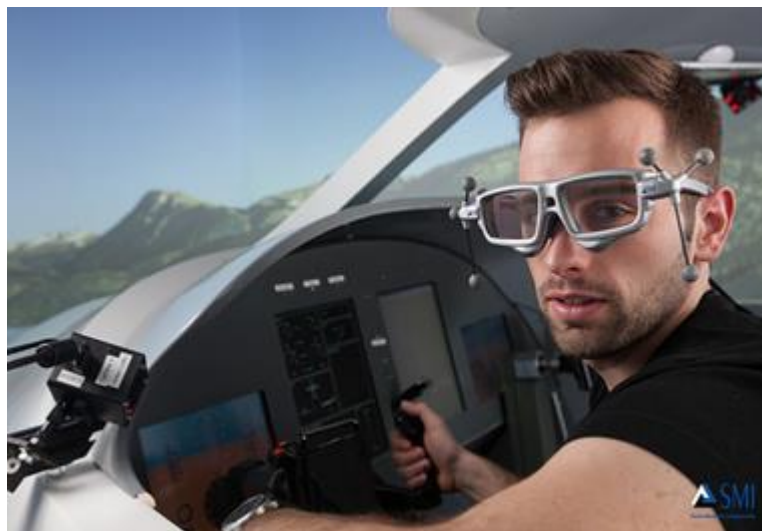
Figura 10. Ejemplo de sistema de eye-tracking portátil.
