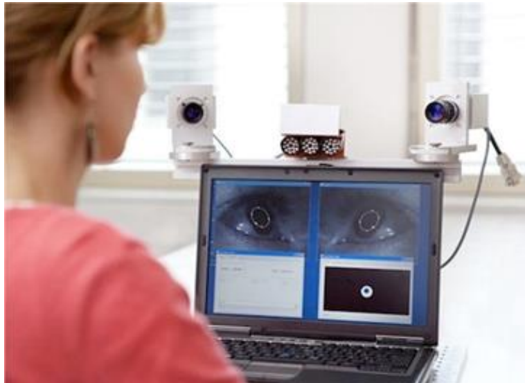
Figura 9. Ejemplo de sistema eye-tracking fijo.
