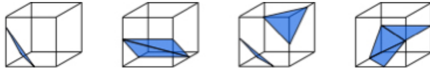
Figura 5.2: Ejemplo con 4 de los patrones del algoritmo Marching Cubes.
