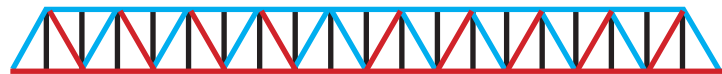
TIPO WARREN_VARIANTE CON MONTANTES VERTICALES (soporte del cordón superior y estructura plataforma)
