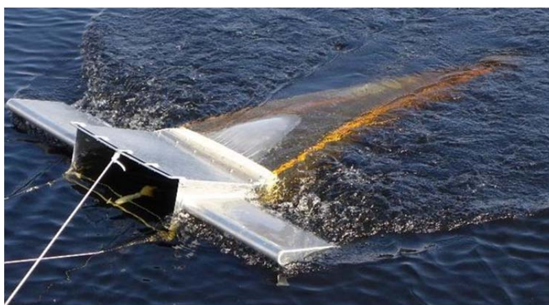
Figura 1.10. Ejemplo de red Neuston o red manta. Fuente: Booth et al., (2018).
