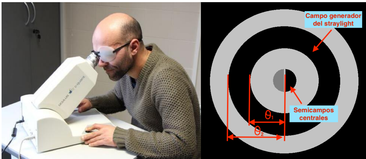
Figura 25. Participante usando el dispositivo de medida Oculus C-Quant (izquierda) y test que emplea el dispositivo para medir el velo luminoso por el método de compensación por comparación (derecha).
