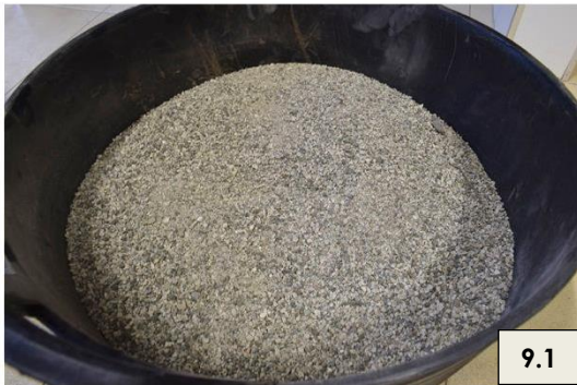
Figura 9.1. Partimos de una porción de residuos de construcción y demolición procesados en una planta.
