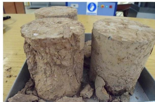
Figura 14. Ensayo de rotura a compresión simple en probetas de suelo.
