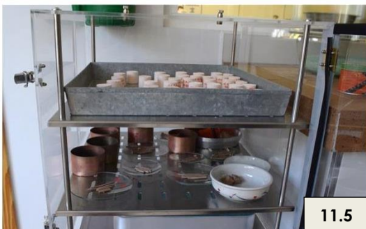
Figura 11. Determinación del Límite Líquido y del Límite Plástico de una muestra
