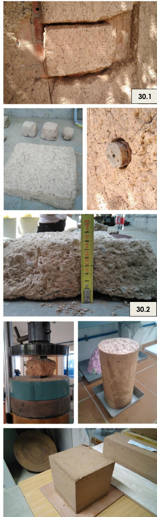
Figura 30. Extracción de muestras del revestimiento proyectado y elaboración de probetas.
