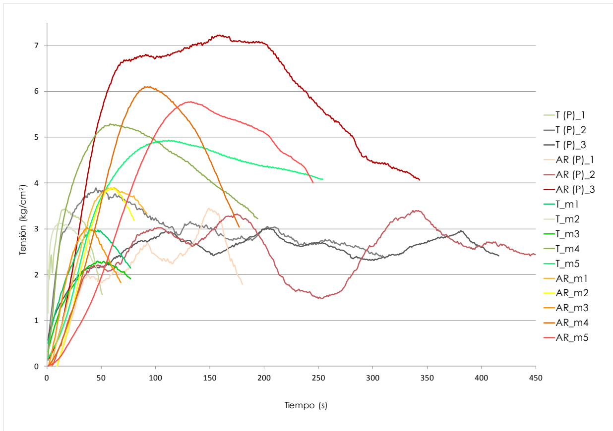
Figura 31. Resultados del ensayo a compresión simple de muestras correspondiente al revestimiento ejecutado mediante la técnica de Tierra Proyectada® de la muestra patrón (T (P): tierra proyectada; AR (P): tierra con áridos reciclados proyectada; T_mx: probetas de tierra patrón; AR_mx: probetas con áridos reciclados de tierra patrón).
