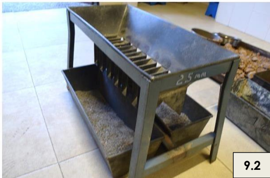
Figura 9.2. Cuarteamos la muestra para dividir dicha muestra en porciones representativas y con el peso necesario.
