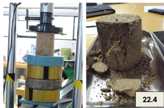
Figura 22. Ensayo de rotura a compresión simple en probetas de suelo (Tierra + AR).
