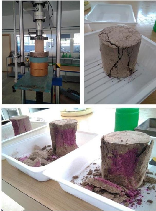
Figura 27. Ensayo de rotura a compresión simple en probetas de suelo (Tierra + AR + Ca + Ce) y comprobación del proceso de carbonatación.
