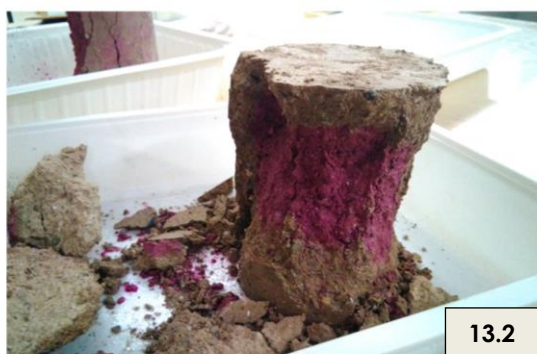
Figura 13. Ensayos de envejecimiento: cámara de carbonatación acelerada y test de fenolftaleína.
