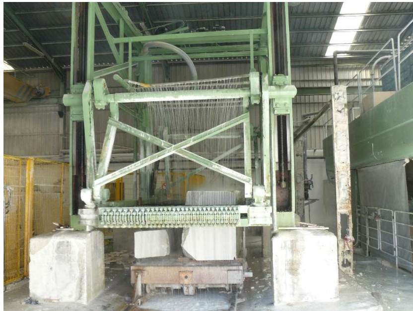
Figura I.2. Corte secundario en Telar de corte.
