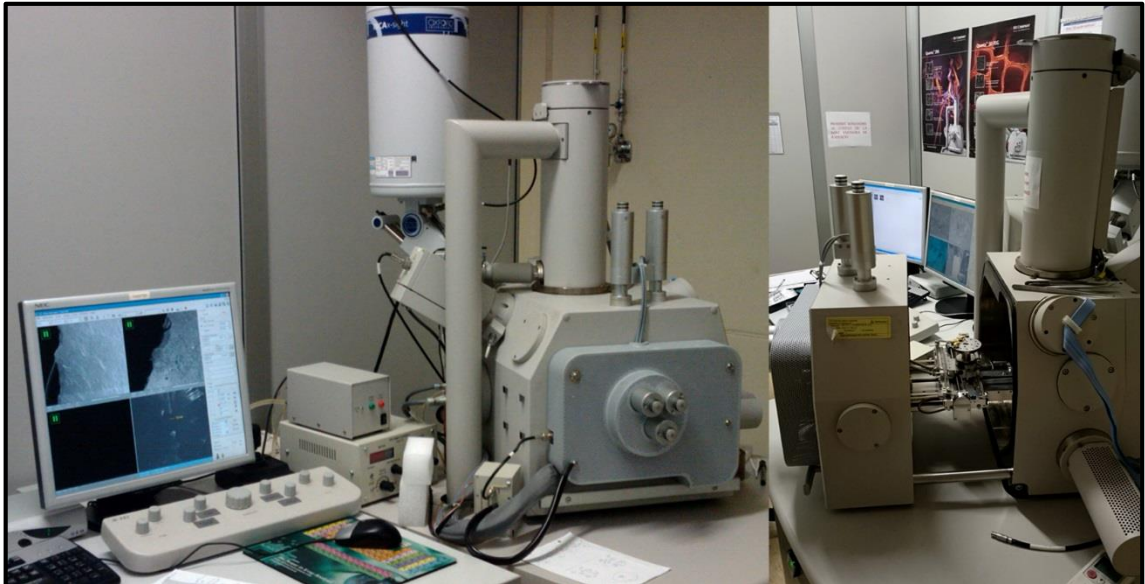
Figura 4.7. Microscopio electrónico de cámara ambiental ( ESEM: FEI QUANTA 600 ) utilizado para el análisis de microdesgaste dental.
