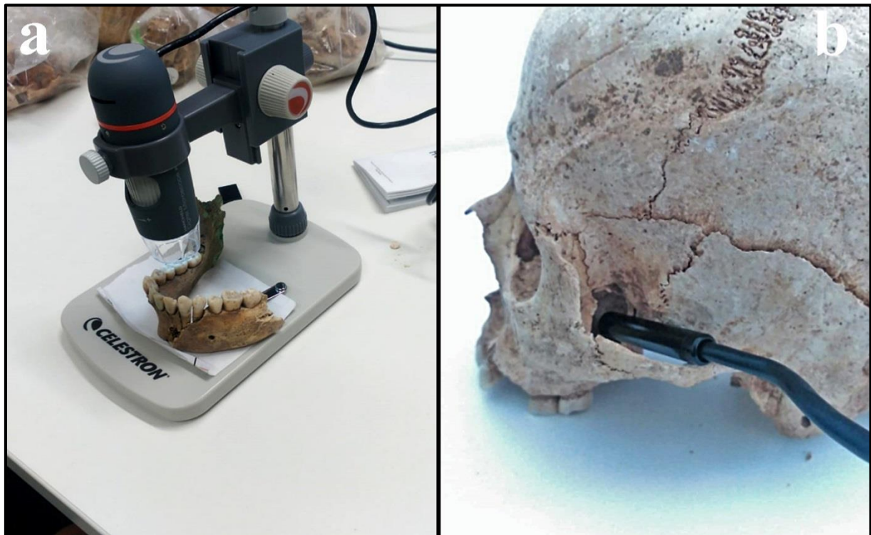
Figura 4.5. Instrumental para el estudio paleopatológico: a. Microscopio electrónico Celestron HDM PRO ; b. Examen del interior del seno maxilar izquierdo con el endoscopio DEPSTECH .
