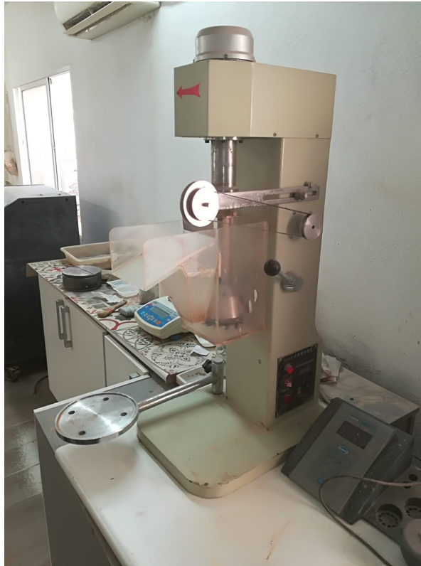
Figura 27: Celda de flotación D12 modelo XFD-II-3
