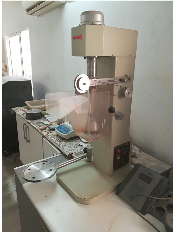
Figura 26: Celda de flotación D12 modelo XFD-II-3
