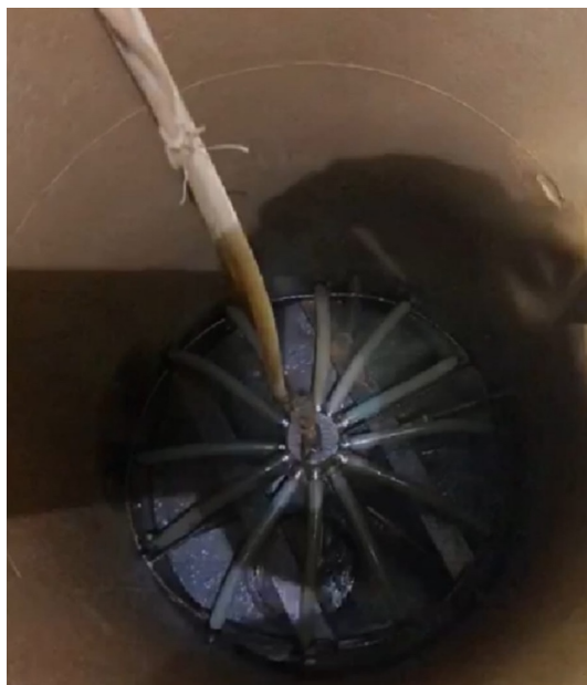
Figura 30: Difusores de PVC en el fondo de la columna
