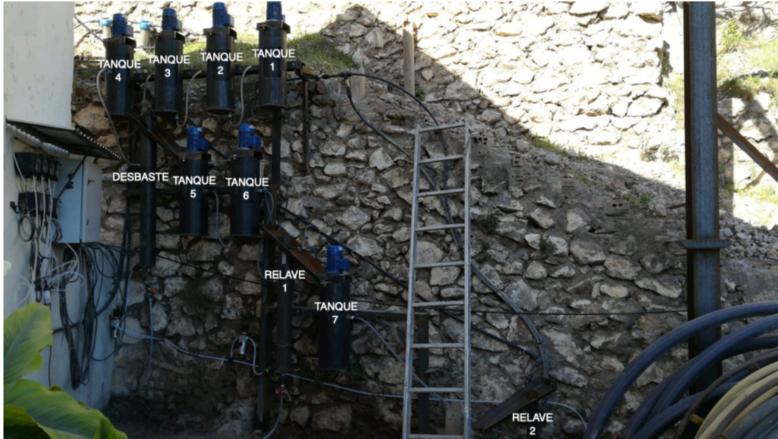
Figura 31: Esquema I de la planta piloto de flotación por columnas
