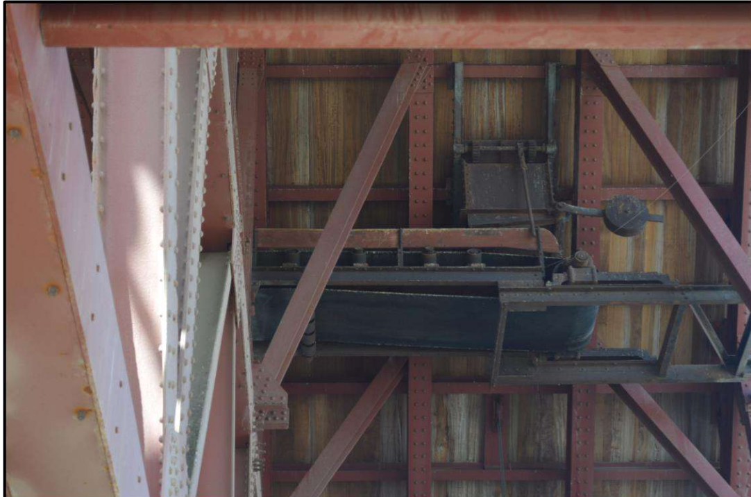
Ilustración 120. Detalle de las cintas transportadoras de mineral de interior del Cable Inglés. Autoría propia.
