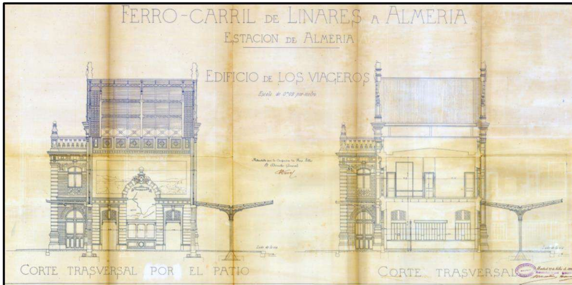
Ilustración 83. Plano del corte transversal del edificio de viajeros de la Estación de Ferrocarril de Almería. Fuente: AHF. Recuperado de Cuadros Trujillo, F. (2015). Laurent Farge y el eclecticismo francés en la estación de ferrocarril de Almería . Ph Investigación , (4), p. 8.
