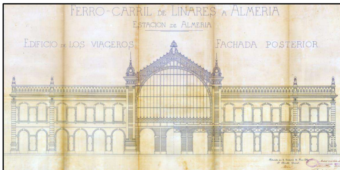
Ilustración 82. Plano del alzado de la fachada posterior del edificio de viajeros de la Estación de Ferrocarril de Almería. Fuente: AHF. Recuperado de Cuadros Trujillo, F. (2015). Laurent Farge y el eclecticismo francés en la estación de ferrocarril de Almería. ph Investigación, (4), p. 6.
