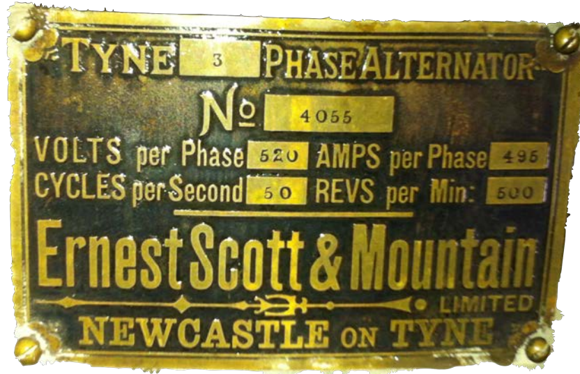
Ilustración 12. Placa de características del generador. Elaboración propia.
