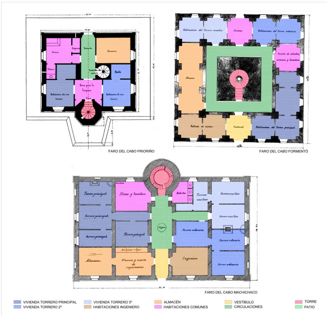
Figura 6: Tipo C. Análisis funcional de los Faros de: Figura 6.1: Cabo Prioriño (1854), Ferrol; Figura 6.2: Cabo Formentó (1863), Islas Baleares; Figura 6.3: Cabo Machichaco (1852), Bermeo Fuente: Elaboración propia. Fuente origen: Puertos del Estado
