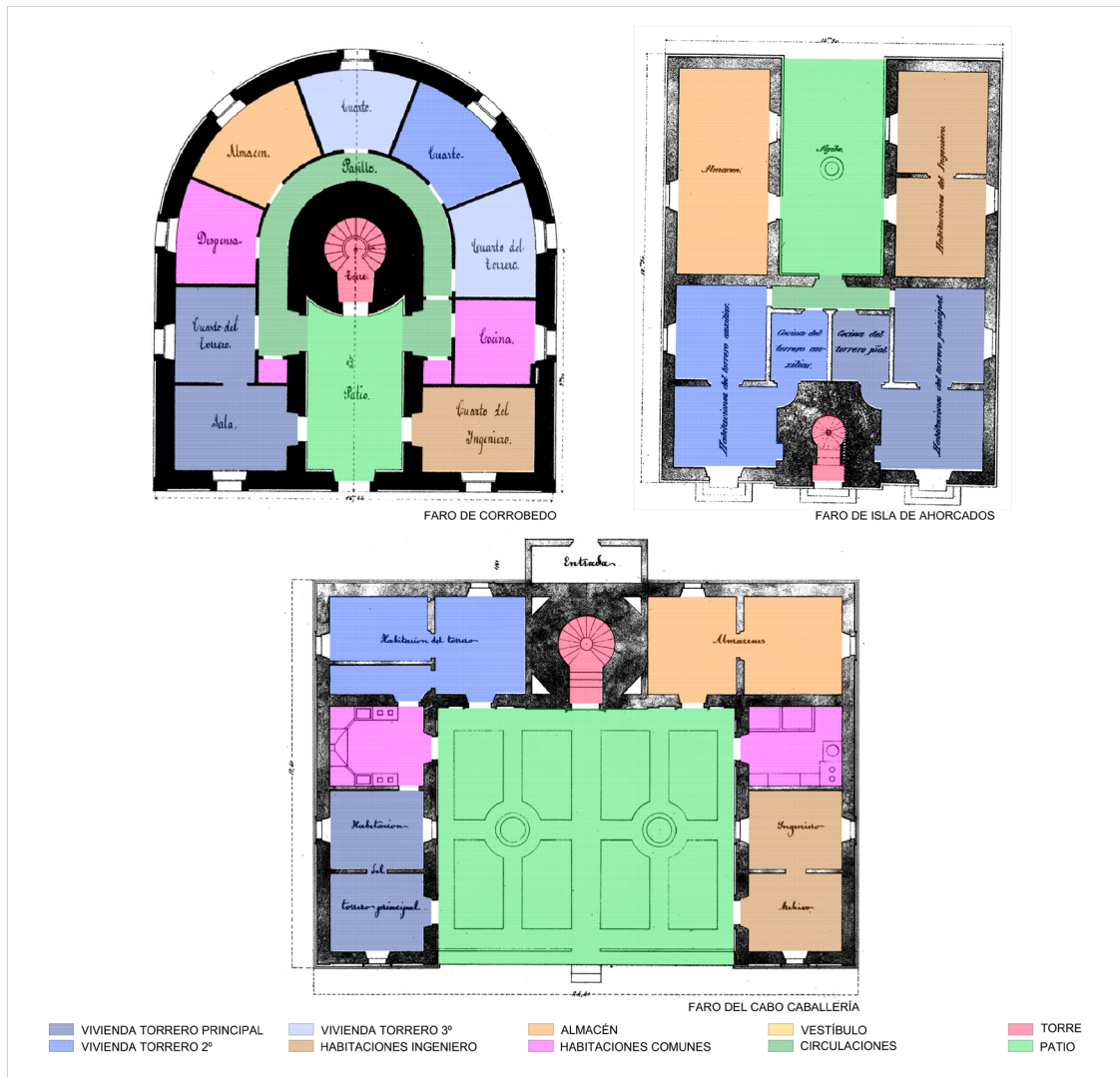
Figura 5: Tipo B. Análisis funcional de los Faros de: Figura 5.1: Corrobedo (1854), A Coruña; Figura 5.2: Isla de Ahorcados (1854-1856), Ibiza; Figura 5.3: Cabo Caballería (1857), Menorca
