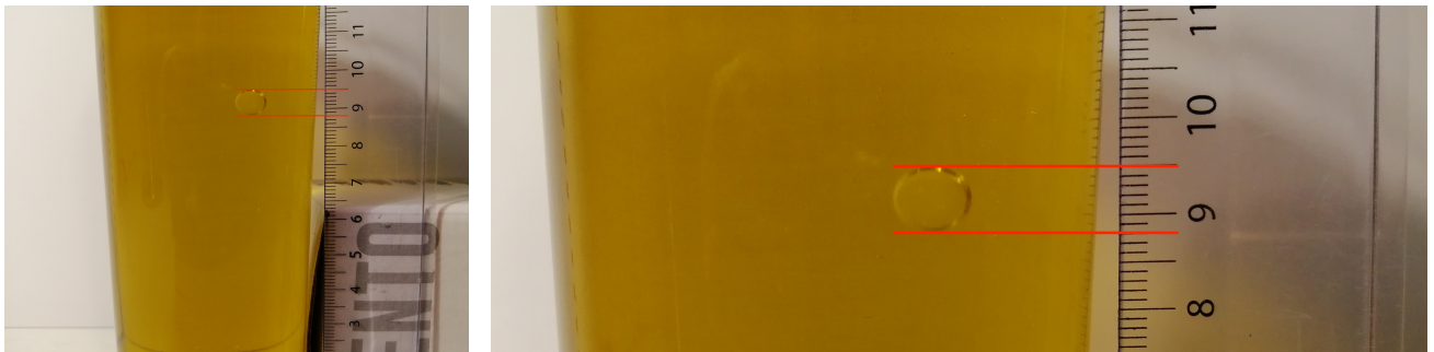
Figura 1. Longitud de una gota medida en vertical durante su proceso de decantación (izquierda). Detalle cercano de la imagen de la izquierda donde se muestra claramente el "diámetro vertical" de la gota, que, en este caso, es de 7 mm (derecha).
