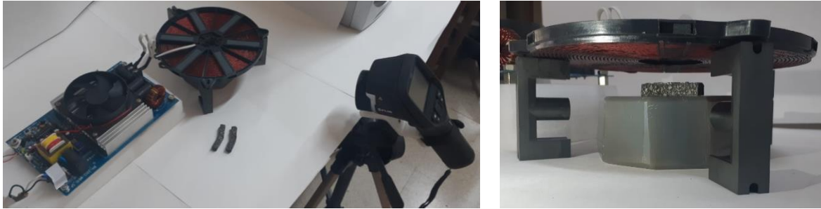
Figura 22. Montaje utilizado para la aplicación de inducción magnética.
