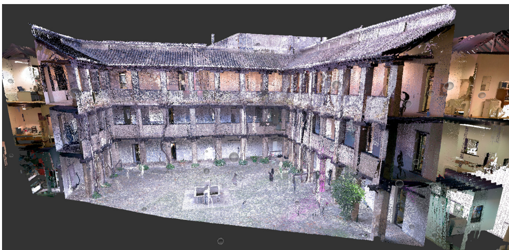
Figura 3. Perspectiva de una sección de la nube de puntos registrados junto a algunas de las posiciones del escáner (esferas grises).
