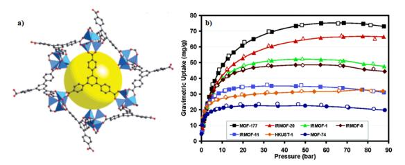
**Figura 23.** *a)* Estructura del MOF-177. b) Isotermas de H<sub>2</sub> a alta presión y 77K de diferentes materiales MOFs.
