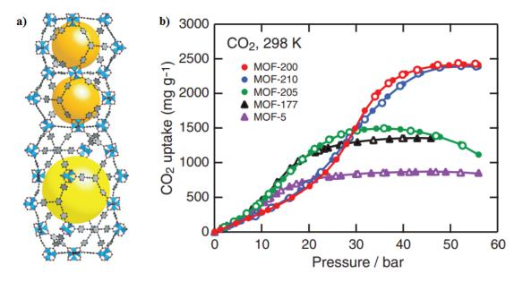
Figura 25. a) Estructura del MOF-210. b) Isotermas de CO<sub>2</sub> a alta presión y 298K de diferentes MOFs.
