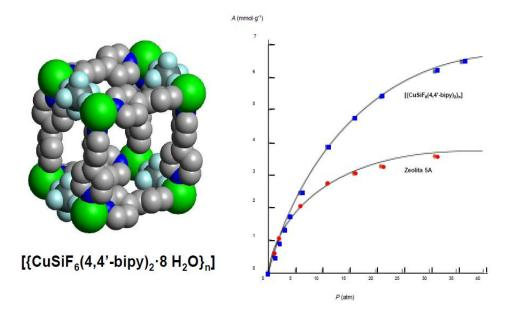
**Figura 24.** *a)* Estructura del [{ $CuSiF_6(4,4'-bipy)_2 \cdot 8 H_2O$ }<sub>n</sub>]. *b)* Isotermas de CH<sub>4</sub> a diferentes presiones y 298K del compuesto comparándolo con la Zeolita 5A.
