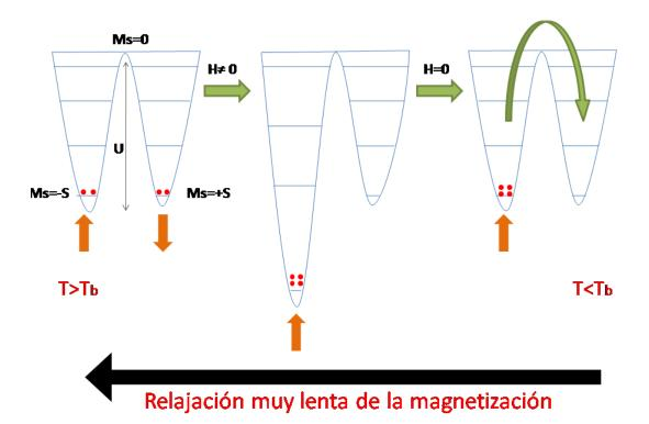
Figura 14. Proceso activado térmicamente para la relajación de la magnetización en SMMs.
