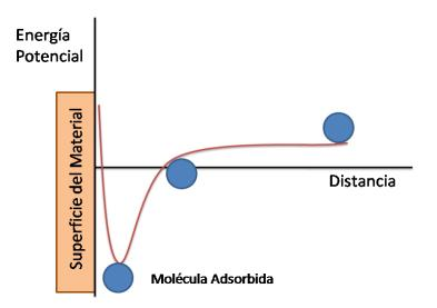
Figura 22. Proceso de acercamiento de una molécula de gas a una superficie.
