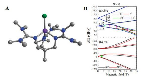
**Figura 12.** (A) Compuesto de Cobalto con anisotropía easy-plane. (B) Simulación del campo paralelo y perpendicular para el compuesto de Co con una anisotropía positiva.<sup>58a</sup>
