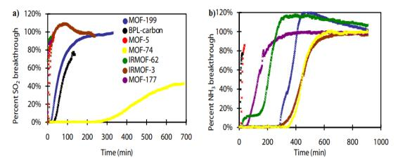
**Figura 26.** *Curva de ruptura para contaminantes gaseosos para diferentes MOFs (a) SO*<sub>2</sub> y *(b) NH*<sub>3</sub>
