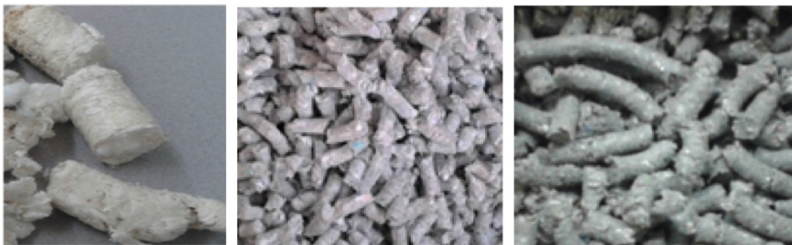
Figura 15: CSRs fabricados a partir de celulosa, plásticos y mezcla de ambos (80%-20%). (Arena y Di Gregorio, 2016).
