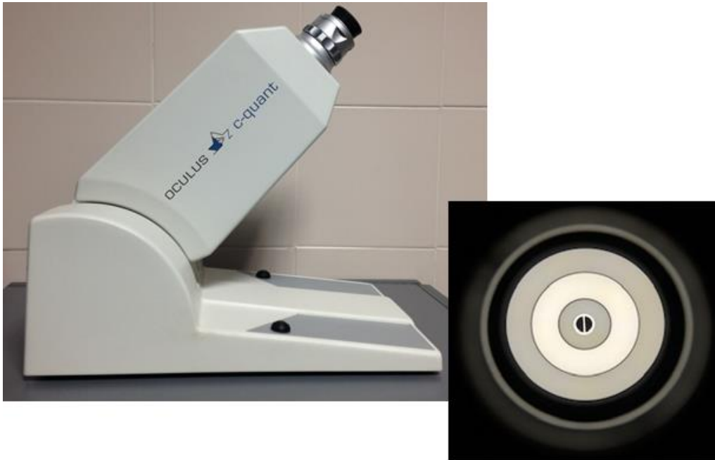
Figura 3.4. Dispositivo C-Quant (Oculus) para la medida del straylight (izquierda) y test presentado al sujeto durante el examen (derecha).
