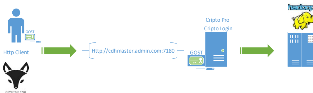
Figura 109 Esquema de autenticación usuarios en Hadoop con certificado GOST.
