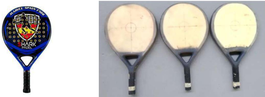
Figura 4. Palas Marvel de Shark Pádel S.L. Izquierda: pala terminada. Derecha: tres de los especímenes, en bruto, ensayados en este trabajo.
