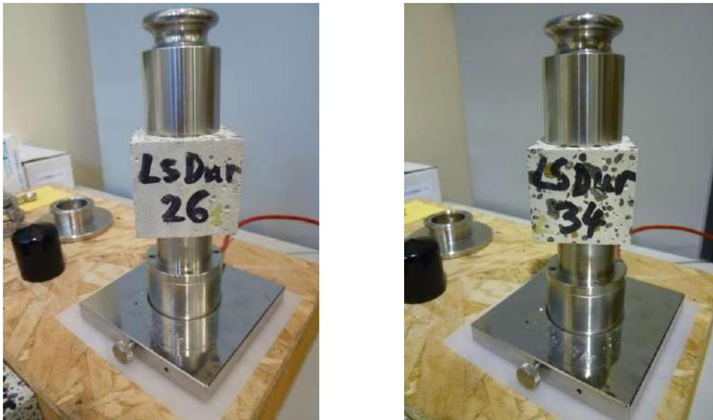
**Figura 3.** Realización de ensayos de conductividad térmica con MTPS.
