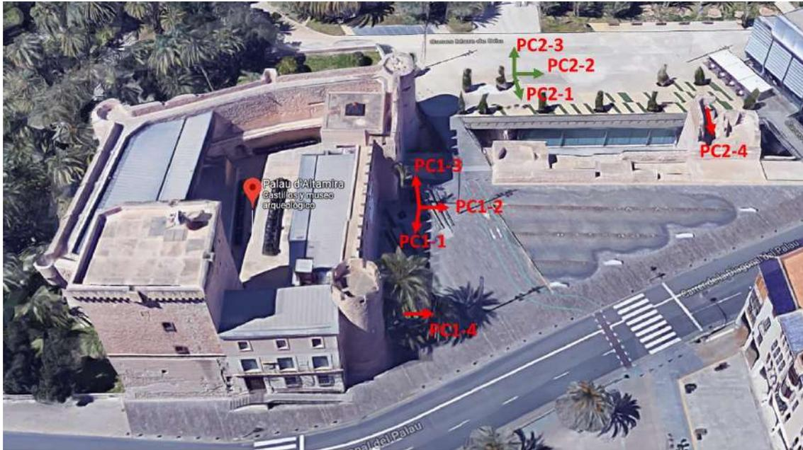
**Figura 7.** Localización y orientación de los acelerómetros el segundo día de ensayo.
