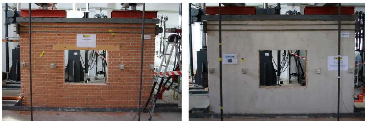
**Figura 3.** Muros sin reforzar y reforzados con TRM.
