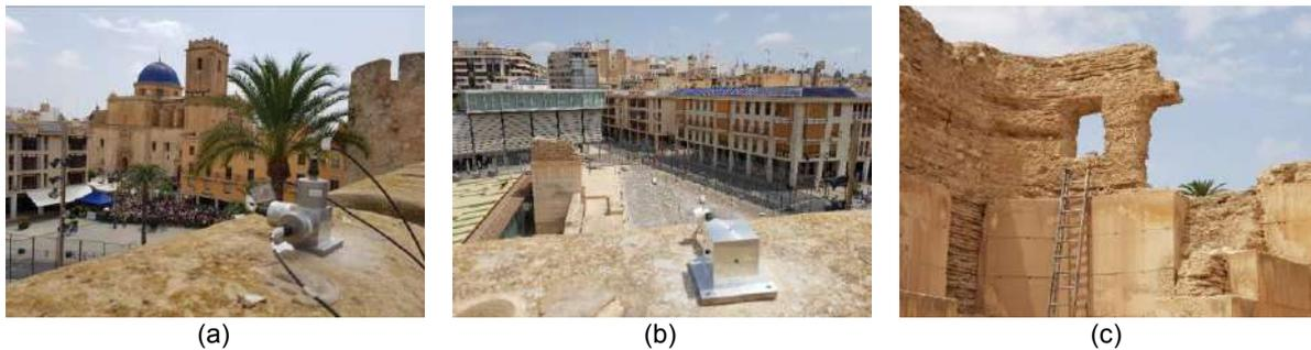
**Figura 5.** Detalle de ubicación de los sensores: (a) Triaxial sobre la almena del Palacio Altamira. (b) Uniaxial sobre la almena del Palacio Altamira. (c) Uniaxial sobre el tramo de muralla.
