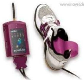
**Figura 2.** Sistema telemétrico pedar-insole-shoe (Fuente: <http://www.novelusa.com>).
