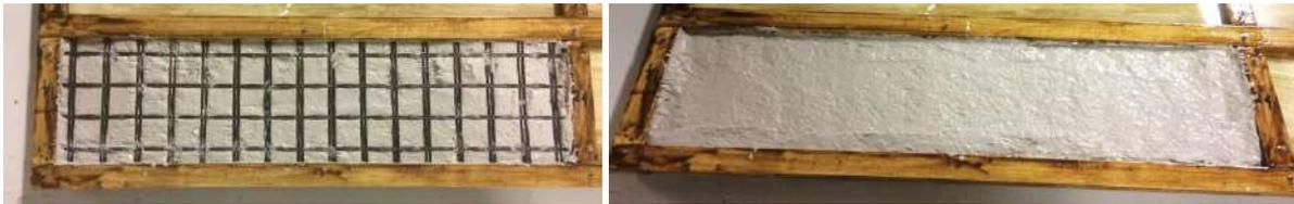
**Figura 1.** Fabricación de las probetas de FRCM: colocación de malla sobre capa inicial de mortero (a) y segunda capa de mortero (b).
