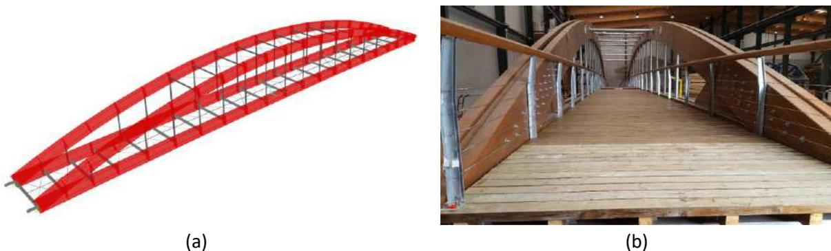
Figura 5. Modelado realizado por elementos finitos en SAP2000 (a) de la pasarela de madera (b)
