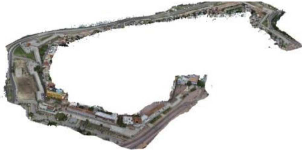
Figura 157. Modelación de los tramos de las murallas tomadas desde el dron y con la cámara reflex
