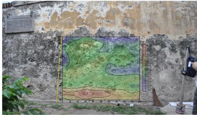
Figura 166. Variación de temperaturas en zona de estudio edificio militar de las Bóvedas
