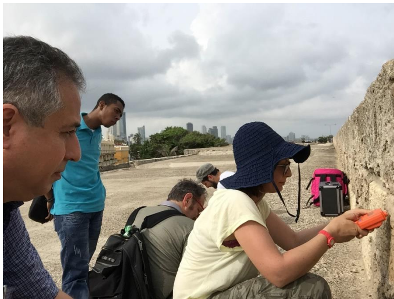
Figura 175. Toma de humedades y temperaturas a piedras baluarte de Santodomingo
