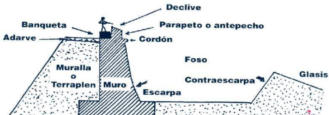
Figura 1. Explicación gráfica de muros con parapetos
