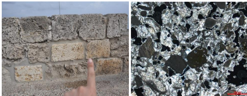
Figura 182. Micrografía de la sección delgada (luz transmitida, Nicols +) de la muestra CMP2
