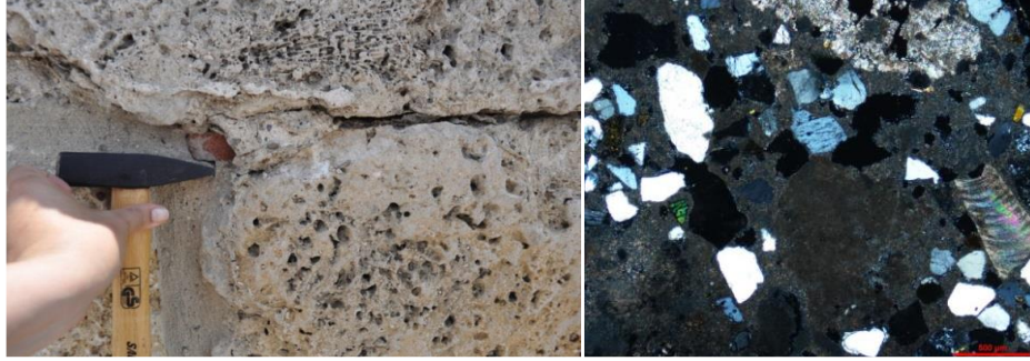
Figura 187. Micrografía de la sección delgada (luz transmitida, Nicols +) de la muestra CMM1
