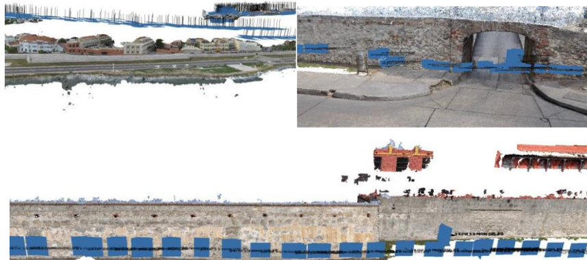
Figura 152. Cubrimiento fotográfico óptimo de las murallas
