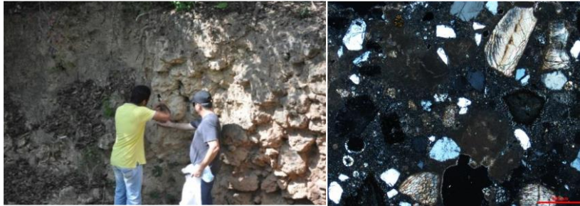
Figura 189. Micrografía de la sección delgada (luz transmitida, Nicols +) de la muestra CTM1
