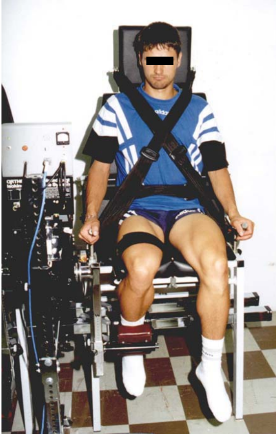
Figura 31. Disposición experimental del sujeto durante la medición isocinética de la extensión de la rodilla.
