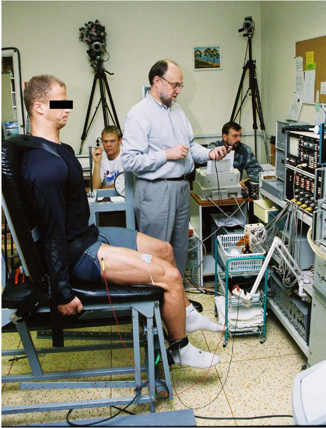
Figura 32. Sujeto ejecutando una contracción máxima voluntaria isométrica en un dinamómetro isométrico de fabricación propia.
