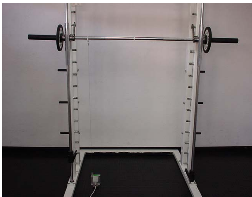
Figura 30. Visión frontal del pórtico de musculación empleado, del sensor de fuerza dinámico del Isocontrol Dinámico 3.0. y del modo en el que el acoplador se coloca respecto a la barra guiada del pórtico.
