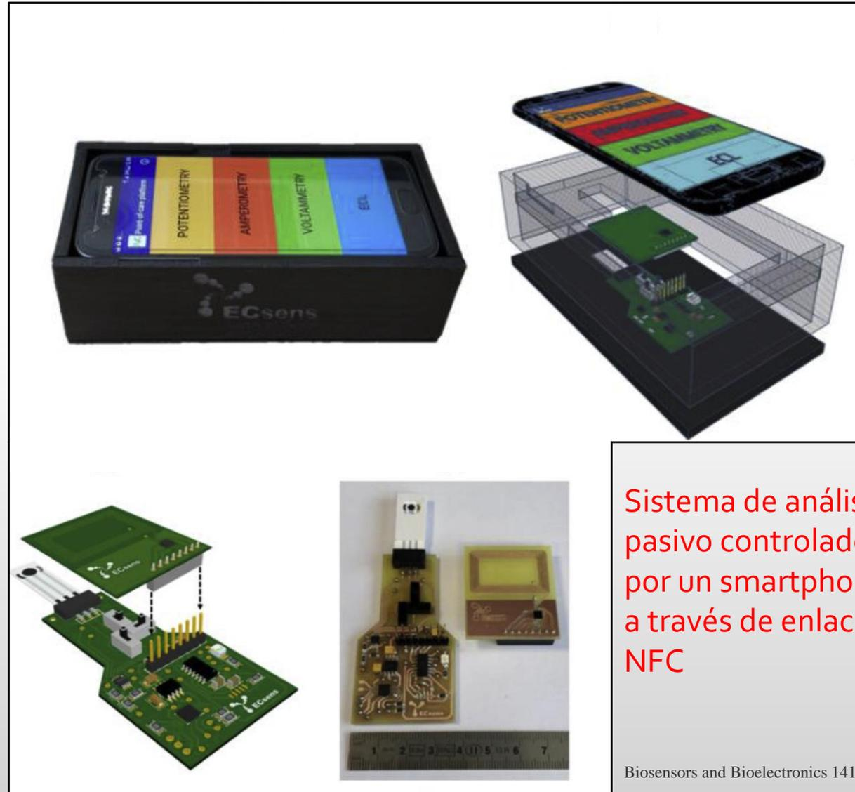
Sistema de análisis pasivo controlado por un smartphone a través de enlace NFC
