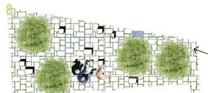
6 plazadura - superficie creada por grandes piezas de piedra con juntas anchas donde crece hierba o se llena de agua, algunas de las piezas tienen mas altura y sirven de bancos.
