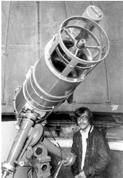
Figura 4. Telescopio reflector de 30 cm de diámetro instalado en el Observatorio Universitario del Mojón del Trigo. Con este instrumento se realizaron los primeros trabajos sobre variabilidad estelar del Instituto de Astrofísica de Andalucía (Crédito: Emilio J. Alfaro).
