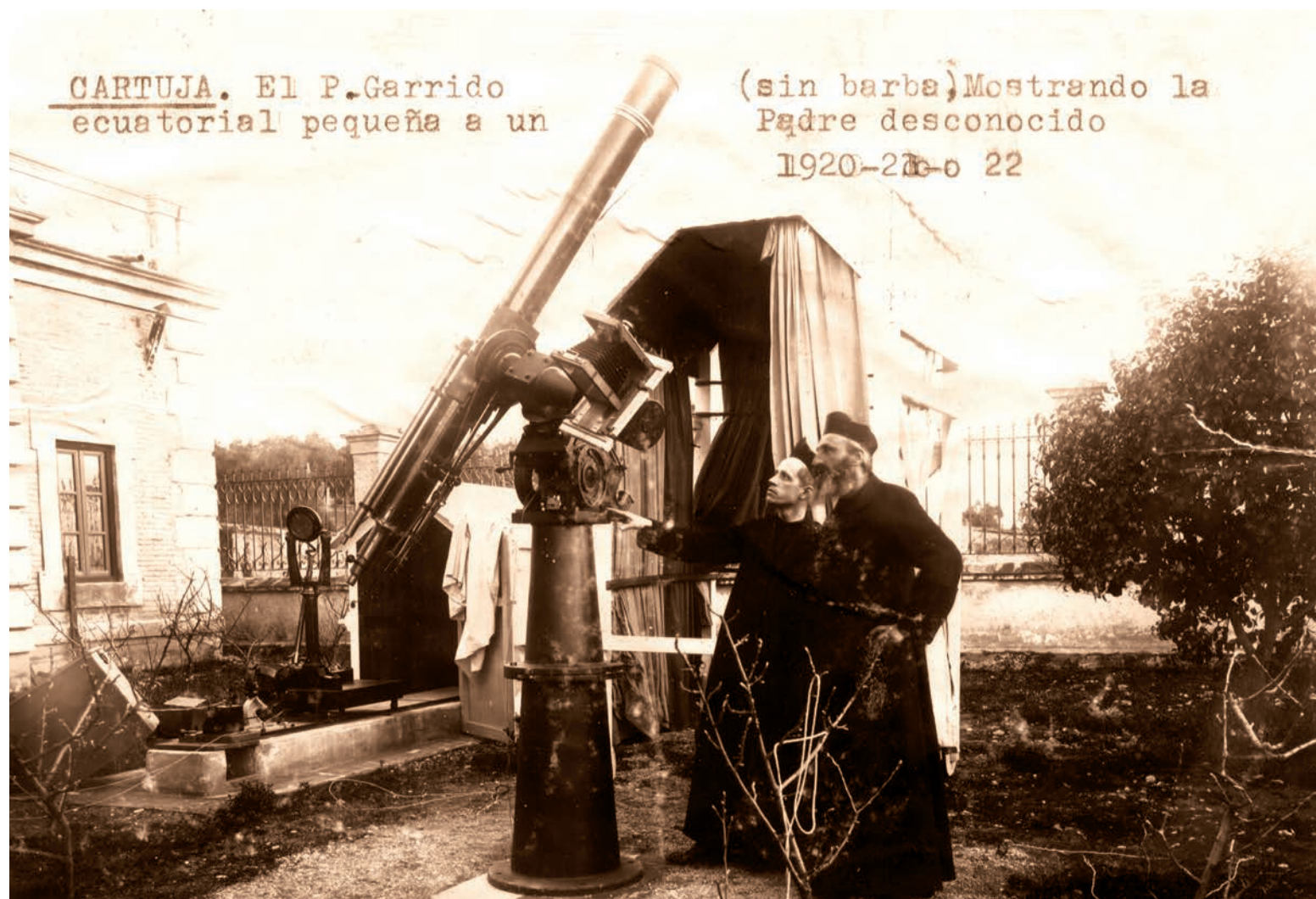
Figura 1. El refractor Mailhat con dos astrónomos jesuitas (el padre Garrido y un desconocido) en el Observatorio de Cartuja (c. 1921). Puede verse la cámara fotográfica asociada a uno de los buscadores, así como la cobertura auxiliar para la realización de las fotos. (Crédito: Instituto Andaluz de Geofísica)
