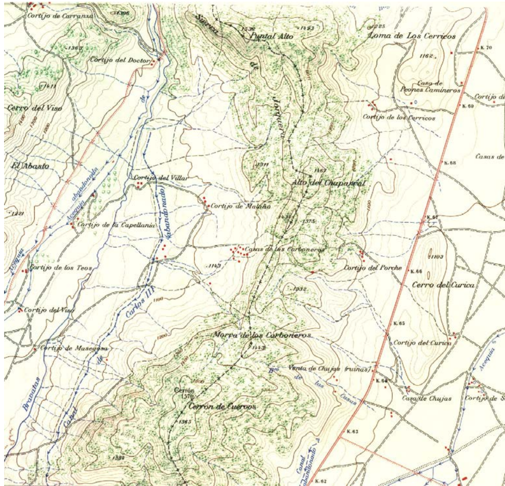
Fragmento de la hoja 930 del Mapa Topográfico Nacional a escala 1:50.000. Se observan las dos ramas del canal faldeando la sierra del Muerto, a la izquierda, y la de la Encantada o Jubrena, a la derecha. El paso del río Bravatás se hacía cerca del cortijo del Doctor.
