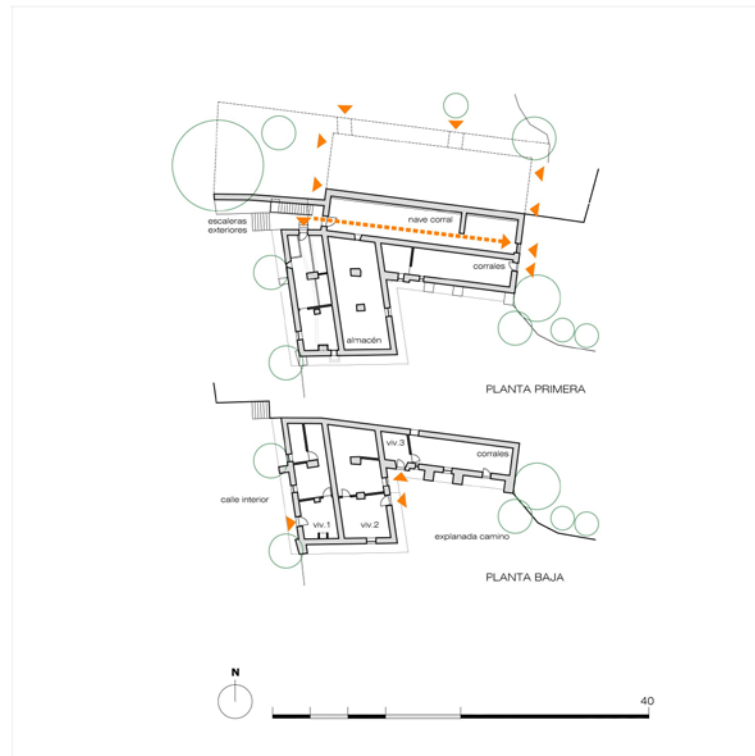
5 Estructura nuclear en ladera con conexiones independientes y una longitudinal a media altura.
