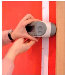
Fig. 7. Medición del color con el Electrofotómetro CM-2500c Konica Minolta (electrofotómetro portátil de mano) en la obra de José Guerrero, Oferta con rojo
