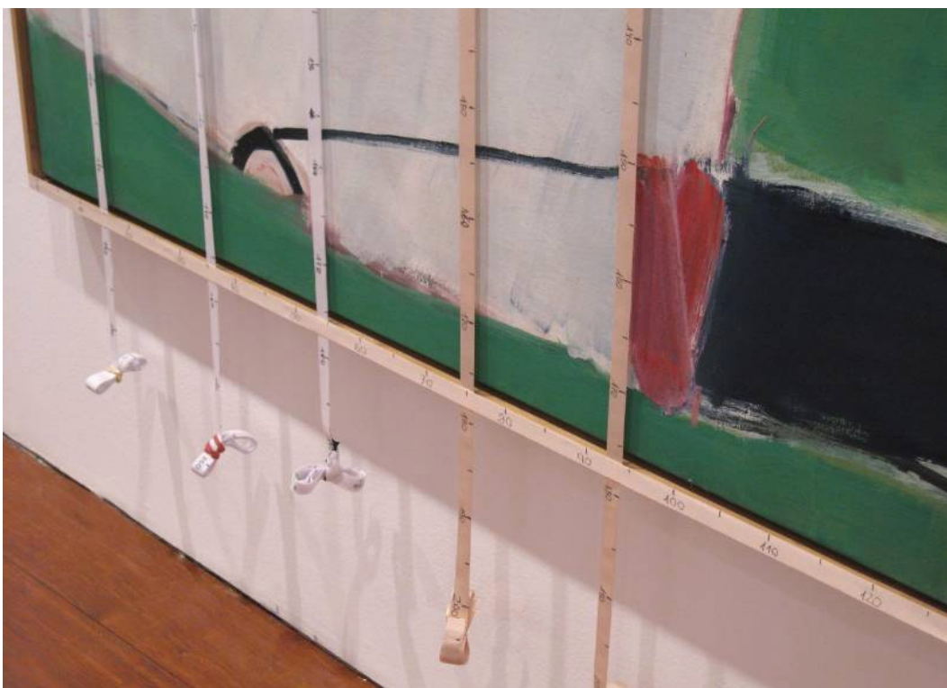
Figura 5.10. Detalle de la colocación de cintas métricas sobre la obra Lateral durante la toma de muestras para establecer la localización espacial de los puntos a medir, formando una red superficial cuadriculada.
