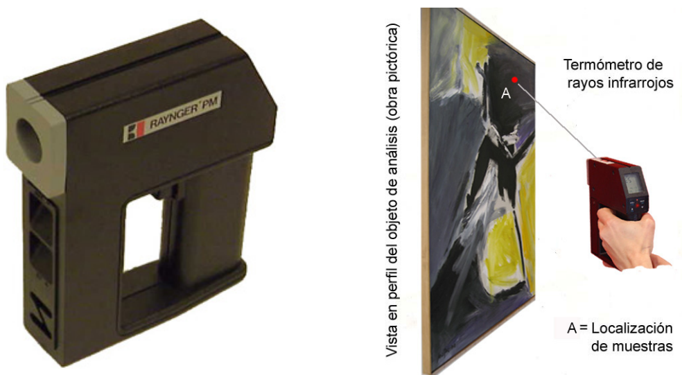
Figura 5.4. Termómetro Láser Raytek, Inc. Raynger PM 2EM y esquema de su metodología de uso.
