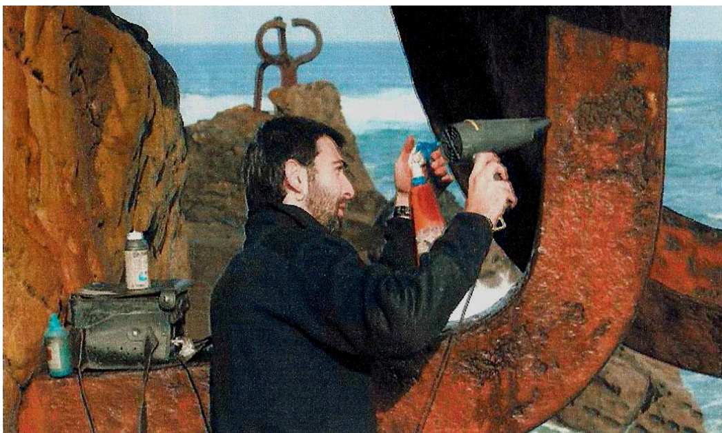
Figura 3.100 Toma de una muestra de material por parte de un técnico de ISNAMET-Tecnalia en el Peine del Viento .
