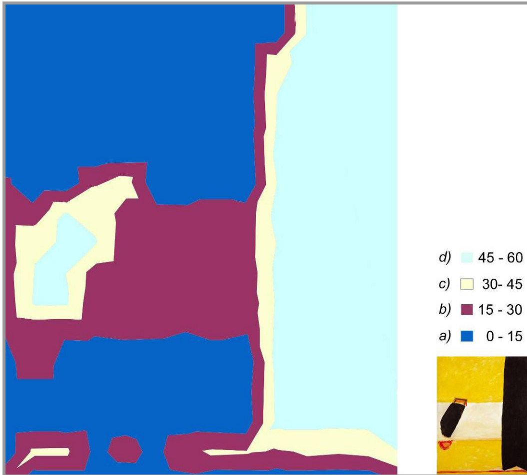
Figura 6.23. Gráfico de isocromas de la obra Lateral negro , 1974, donde se observan diferentes áreas de igualdad de croma, según la ecuación CMC (l:c)(D65). La escala gráfica muestra (colores y letras) diferencias de quince unidades de croma. La imagen de la parte inferior derecha corresponde al cuadro original analizado colorimétricamente.
