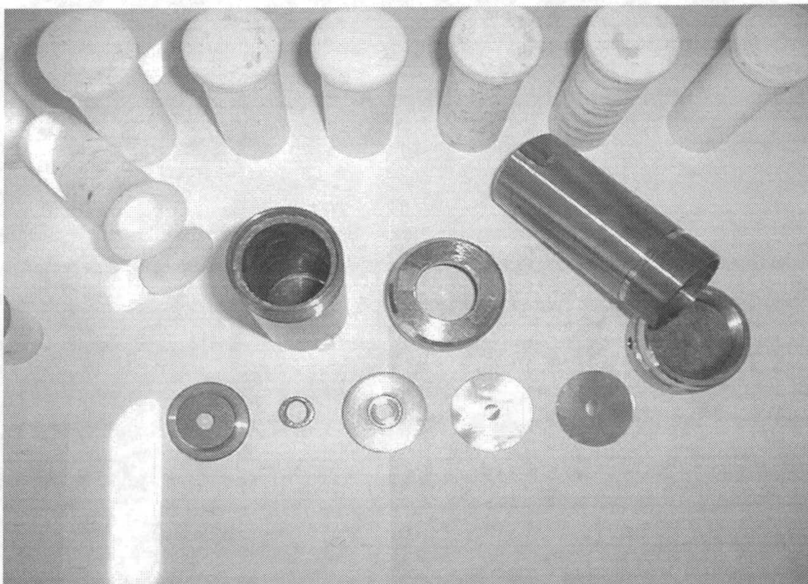
Figura 3.20. : Vista de reactores hidrotermales, (incluidos discos de seguridad y carcasa de acero)
