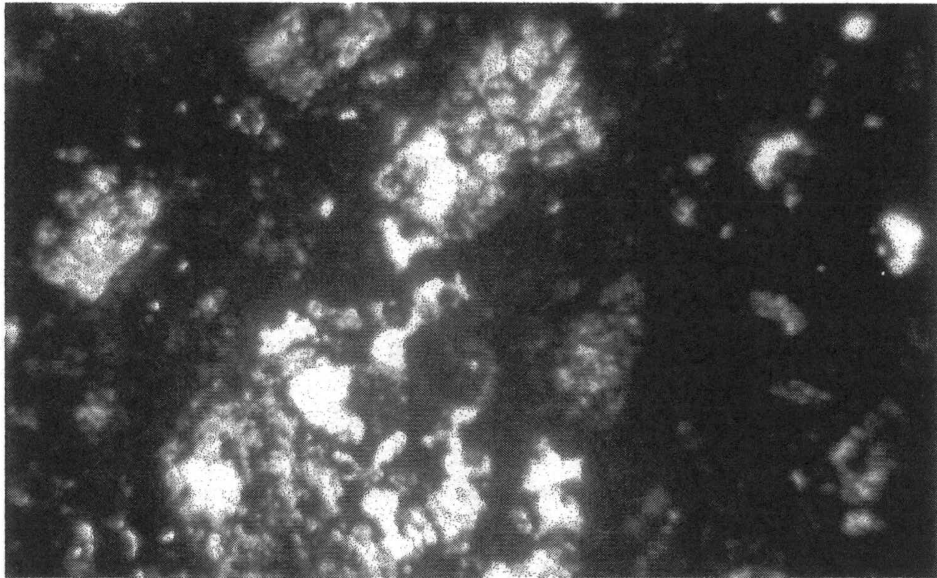
Figura 4.1. Fotografía de microscopio óptico de lámina delgada realizada sobre la muestra correspondiente al material volcánico suprayacente a la bentonita (T-12). En ella se observan texturas de corrosión en los feldespatos y “estructuras fantasmas” de algunos minerales pertenecientes en origen a sulfuros.
