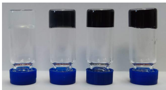
Figura 7. Fotografías de los hidrogeles híbridos FmocFF-SWCNT. De izquierda a derecha: hidrogel FmocFF-control, HH-100, HH-250 y HH-500.
