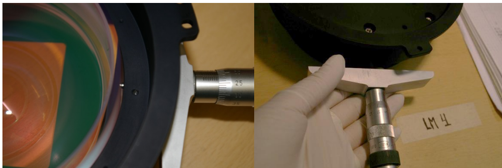
Imagen 5-33: Midiendo posición de la L4 con el micrómetro de profundidad.
