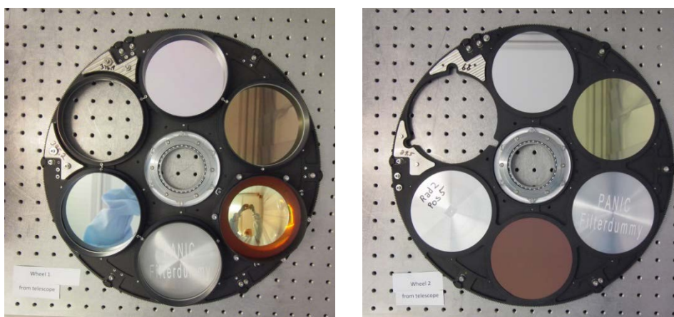
Imagen 5-36: Vista desde el telescopio de las ruedas de filtros 1 y 2. Izqda.: en la rueda 1 los filtros Y (posición 1), H (2) y J (5), la PIL (3) y una posición ciega (4). Dcha.: rueda 2 con los filtros Z (1), K S (2) y H 2 (4), una posición ciega (3).
