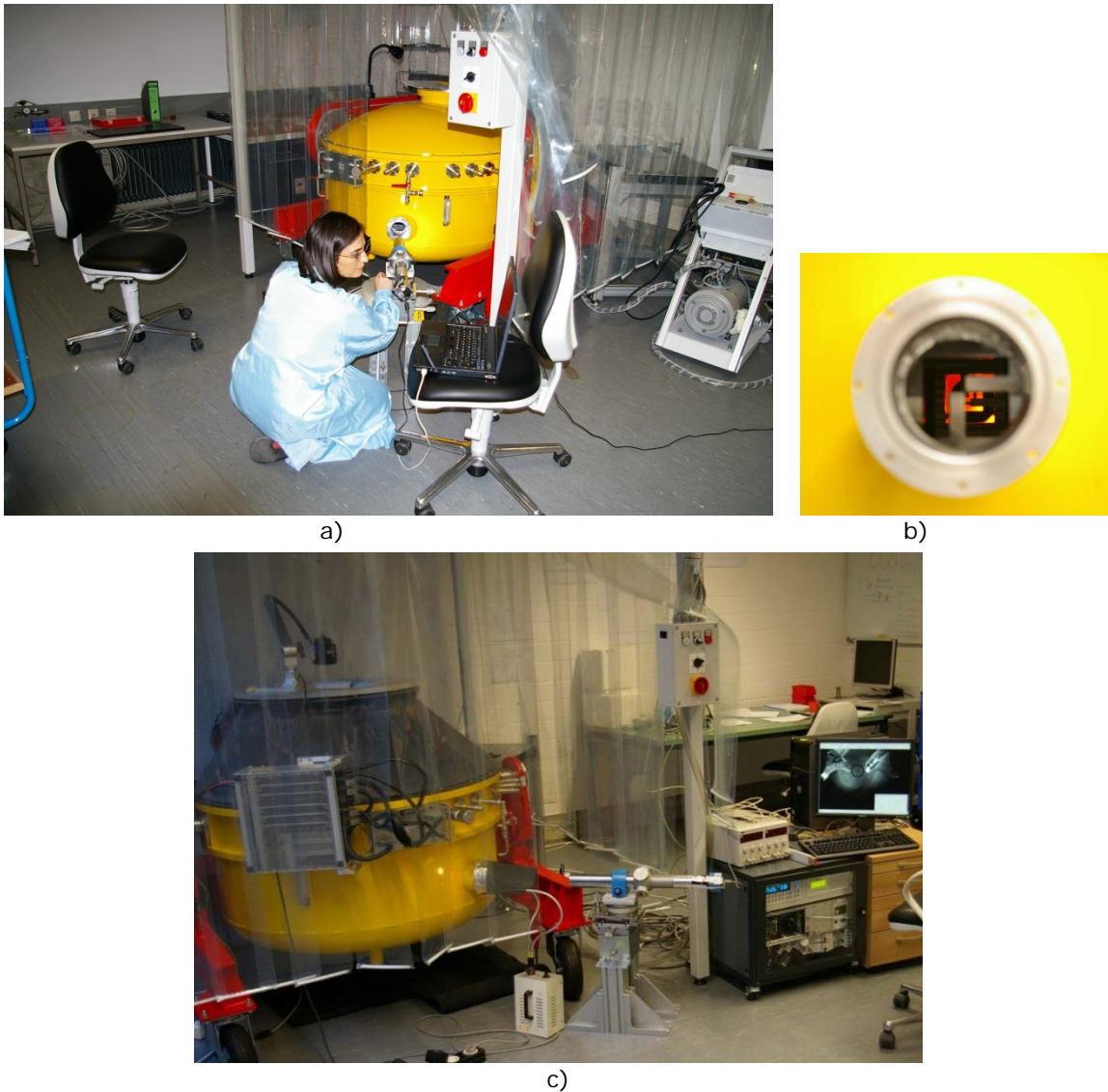
Imagen 5-51: a) y c) Midiendo el eje opto-mecánico en frío a través de la ventana auxiliar de salida con PANIC en posición de operación. b) visual de las dianas vistas a través de la ventana auxiliar de salida.
