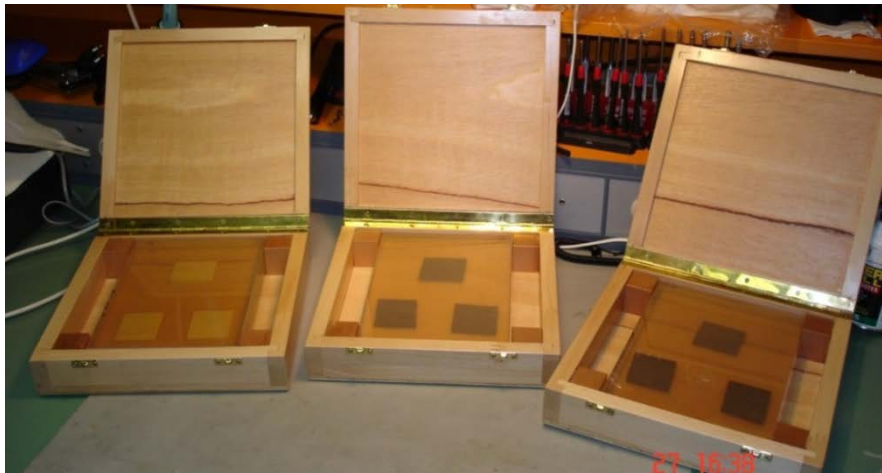
Imagen 5-12: Espejos de doblado sin recubrimiento a su recepción en noviembre de 2009.
