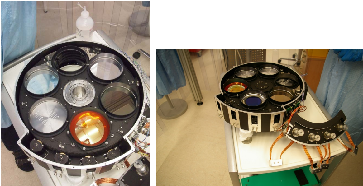
Imagen 5-37: Unidad de ruedas de filtros preparada para su integración en el banco óptico de PANIC.
