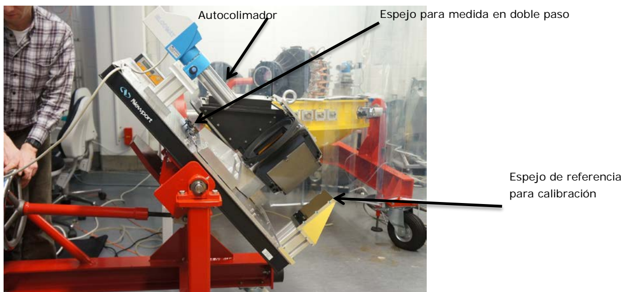
Imagen 5-30: Montaje experimental para la medida dinámica del eje opto-mecánico de la estructura de espejos.
