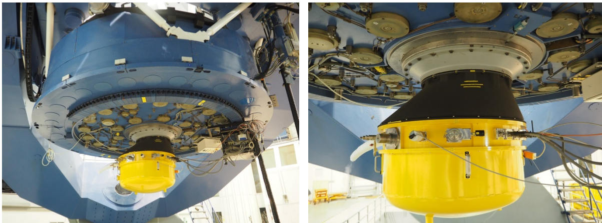
Imagen 5-77: PANIC montada en el foco RC del T35. Se observa la pieza de adaptación de la interfaz del T22 al T35.
