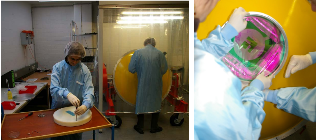
Imagen 5-5: Instalación de la ventana de entrada del criostato en PANIC para hacer su ciclado criogénico para la supervivencia de la misma.
