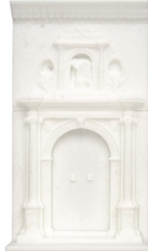
Fig. 52: Modelo realizado por impresión 3D de la portada principal de la Iglesia de San Miguel Bajo a escala 1:50m en dos partes. La portada podría haber sido diseñada por Diego de Siloé y ejecutada por Pedro Asteasu y Juan de Alcántara.
