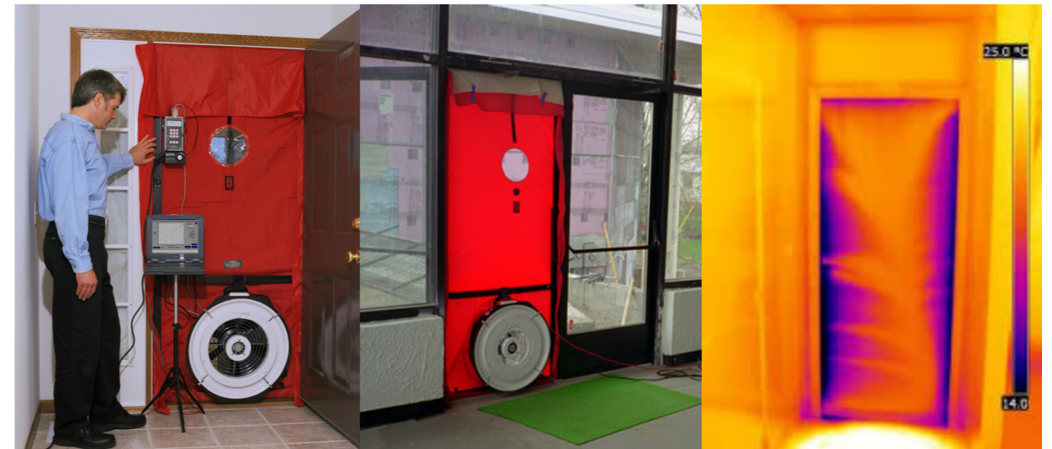
Test de Blower Door
