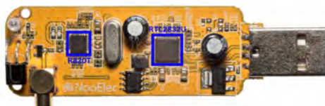
Figura 2.15 – Interior del dispositivo RTL-SDR .
