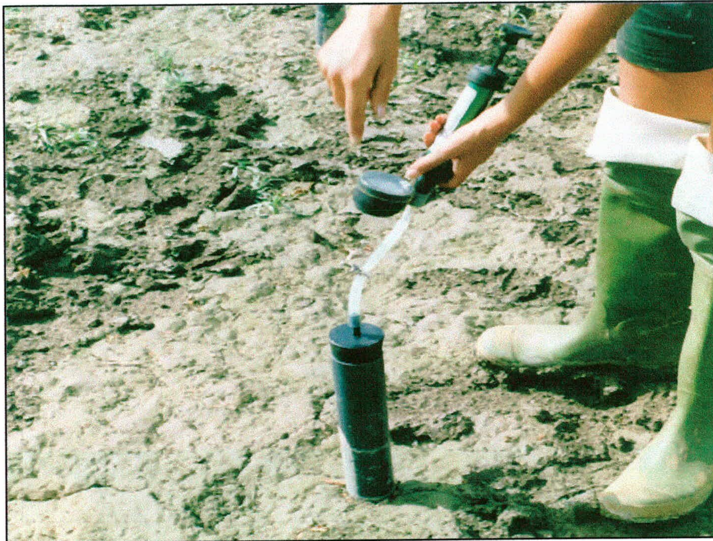
Figura 21.- Aplicación de vacío a las cápsulas de cerámica
