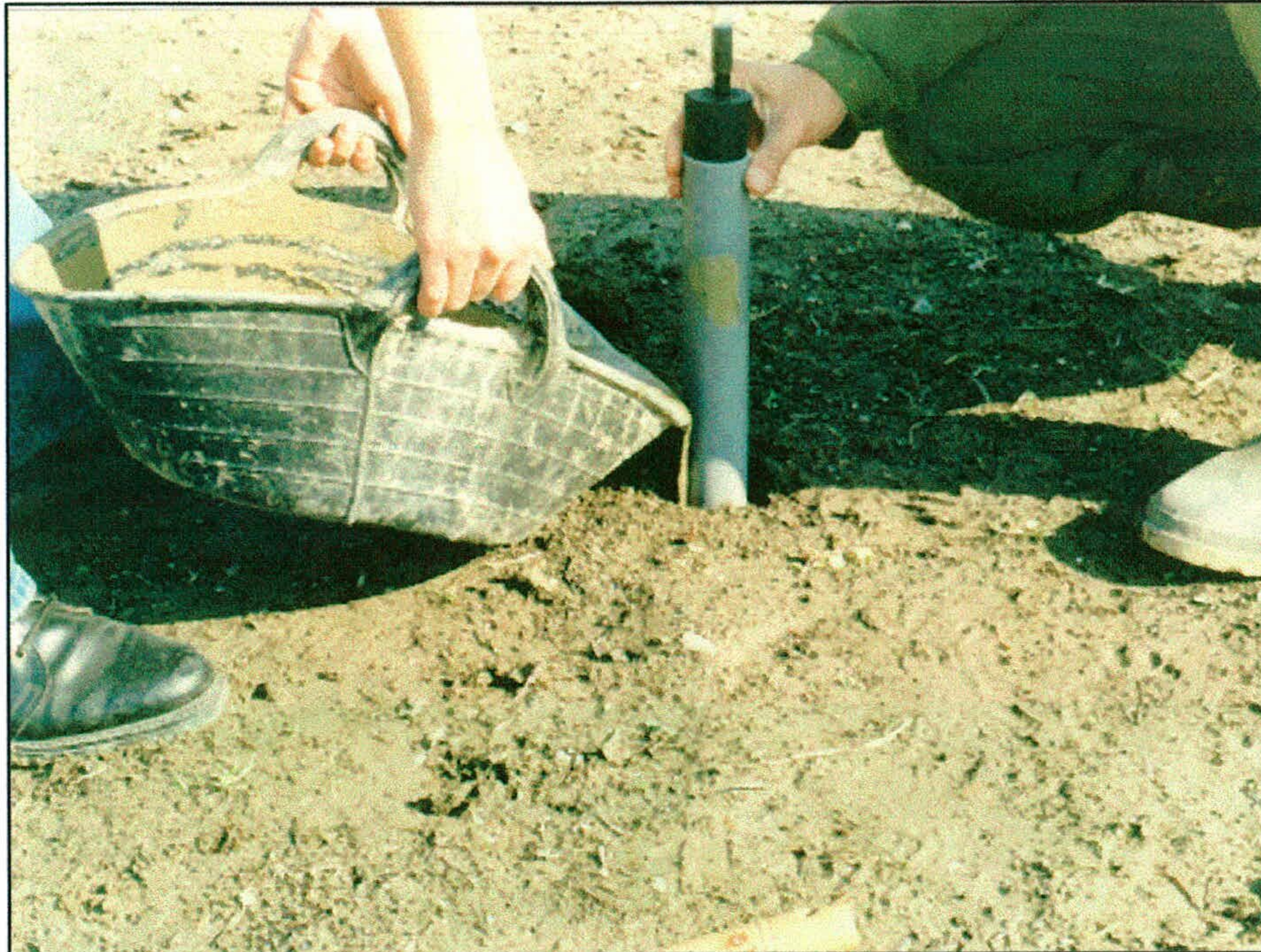
Figura 23.- Instalación de las cápsulas de cerámica.
