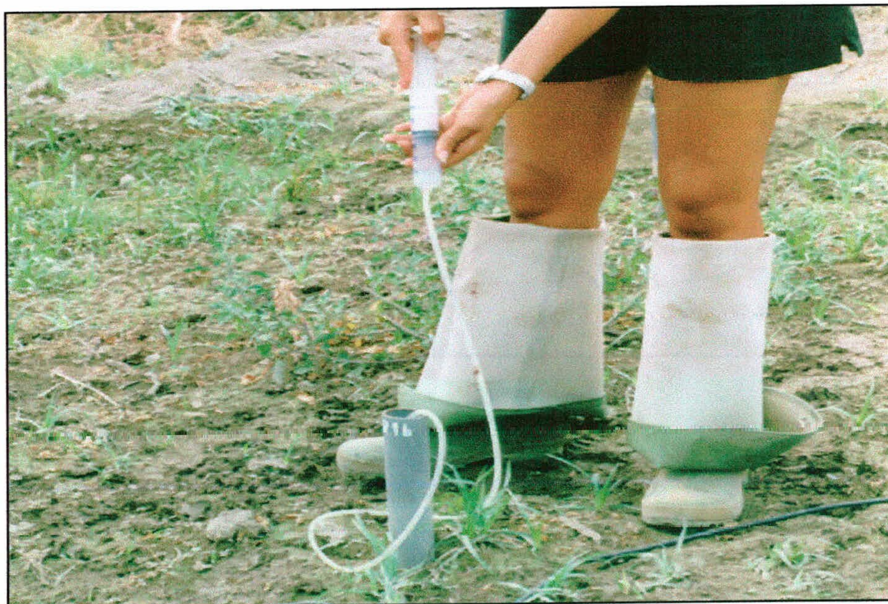
Figura 21.- Aplicación de vacío a las cápsulas de cerámica
