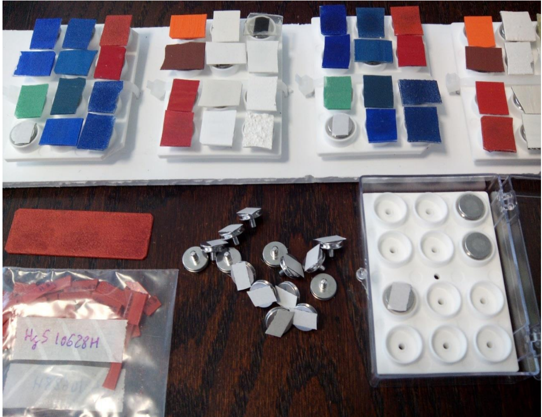
Figura 1.2 Montaje de dosímetros pictóricos (autoría C. Cardell).
