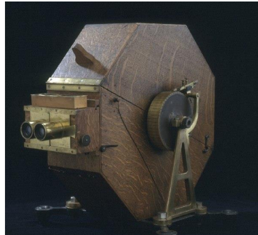
figura 8 Stereoscopic Spark Drum Camera, cámara de alta velocidad construida por Lucien Bull (1904)
